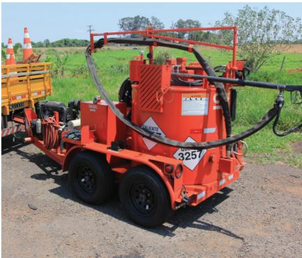
O selante é um material composto de cimento asfáltico modificado com adição de elastômeros de última geração e alto desempenho, o que acaba lhe conferindo aderência, alongamento com memória elástica, flexibilidade e resistência à fadiga, proporcionando assim uma maior capacidade para suportar as movimentações do pavimento.
